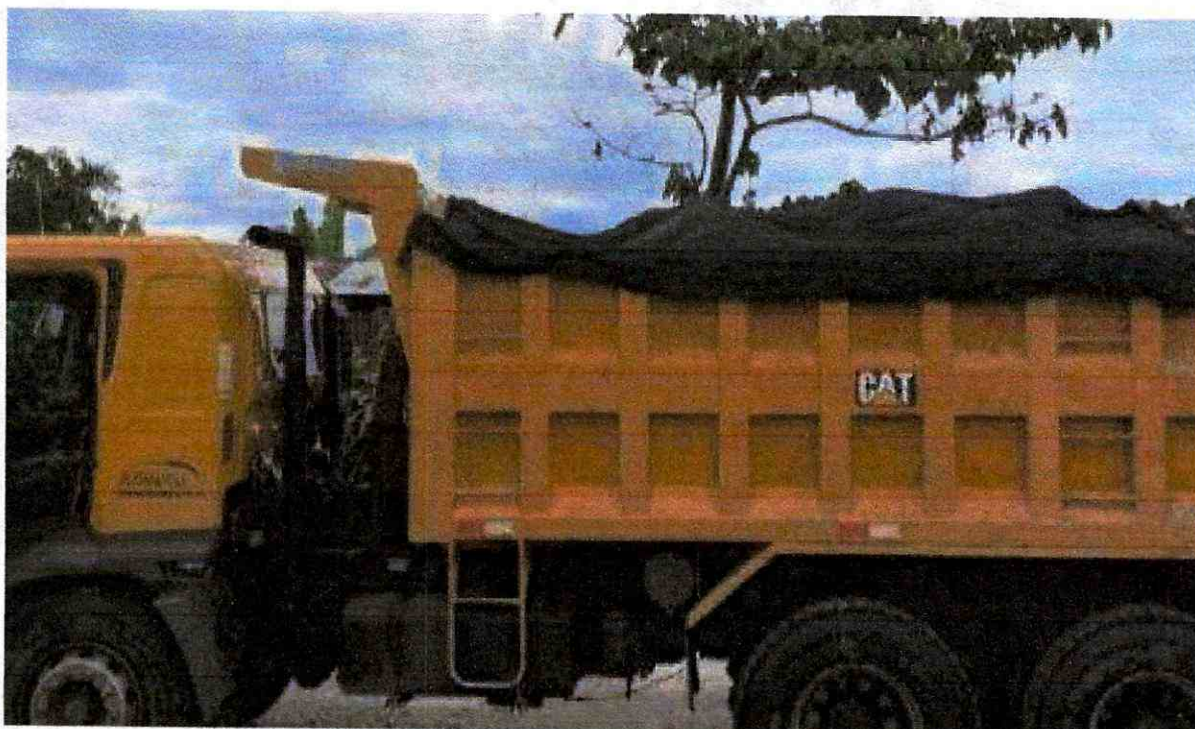
Imagen 4. Volquetas con la cubierta de lona
