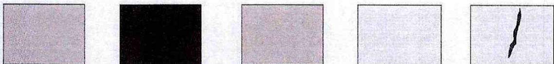
Figura1: Fundamento del ensayo por líquidos penetrantes.
