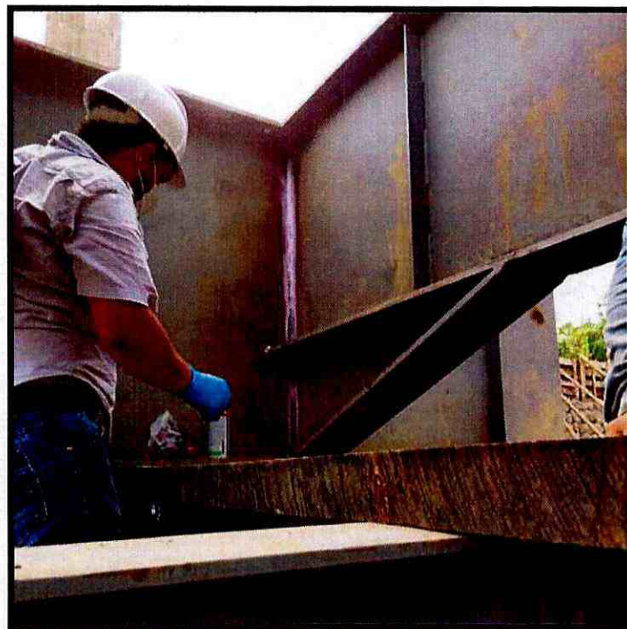
Fotografía 4. Ensayo de tintas penetrantes
