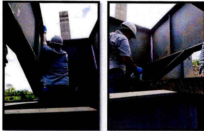
8.- Aplicación del líquido revelador
