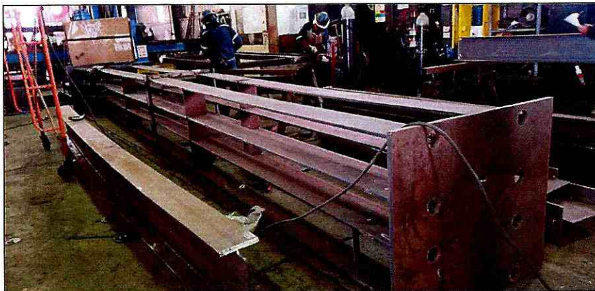
Fotografía 18: fabricación de acero A 588
