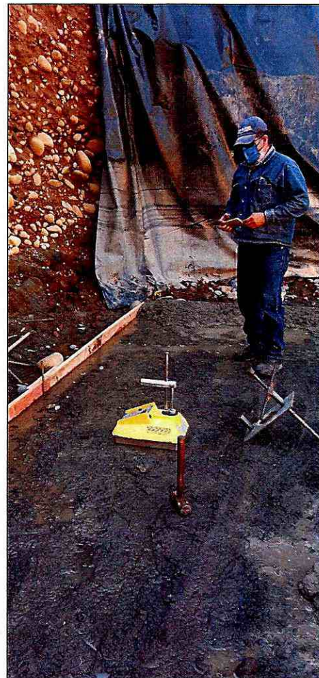
Fotografía 4 y 5: ejecución de ensayos para verificar la compactación del suelo
