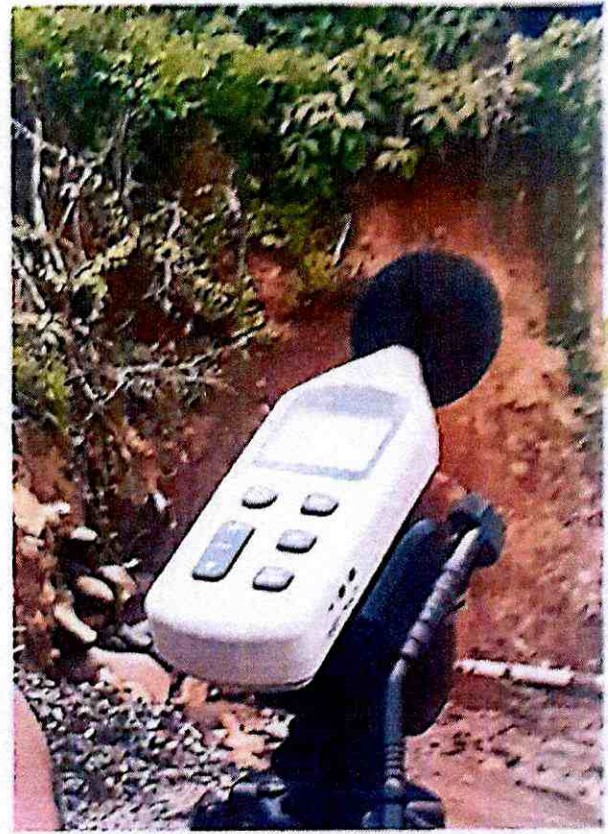
Sonómetro de medición de ruido.
