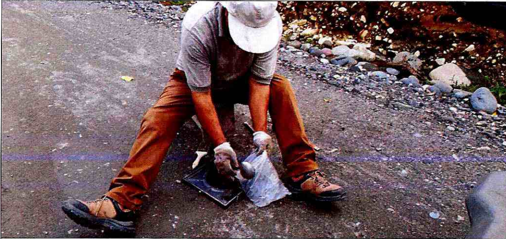
Ensayo de densidad con Cono y Arena
