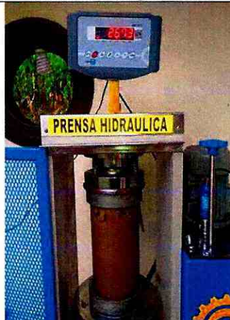
Ensayo de compresión a cilindros de Hormigón Simple
