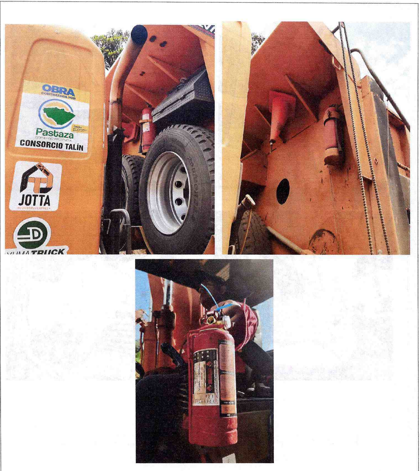
Fotografía 18,19 y 20. Extintores operativos en vehículos pesados (volquetas y excavadora).
