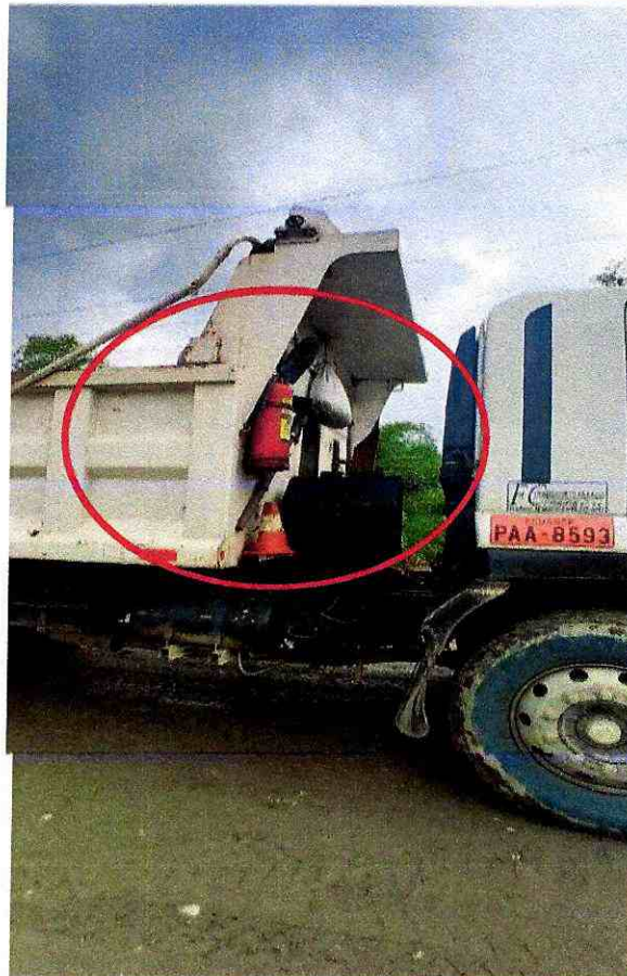
Fotografía 7 y 8 . Extintores en vehículos pesados.
