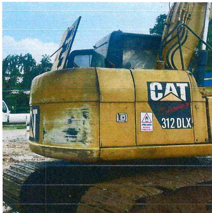
SEÑALETICA CONTRA PELIGROS POTENCIALES DE INCENDIOS
