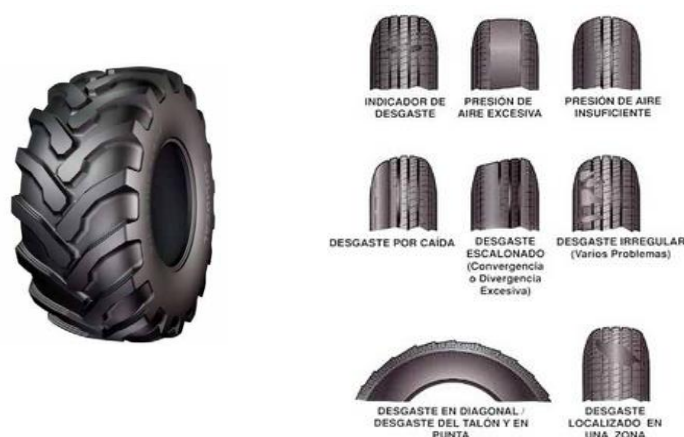
Ilustración 1 Tipo de desgastes en Neumatico FUENTE: https://www.lacasadelneumatico.com
